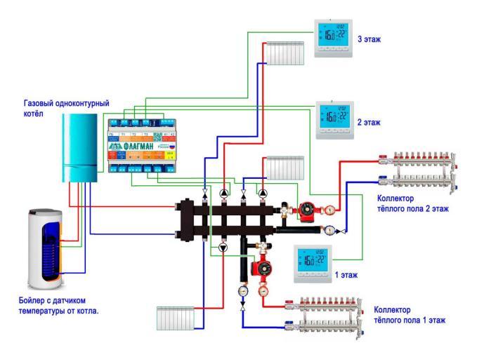
Как видите, на первом и втором этажах есть и радиаторы, и водяной тёплый пол. Для этого на эти два этажа не только напрямую работают циркуляционные насосы для радиаторов, но и насосно-смесительные узлы для тёплого пола.
