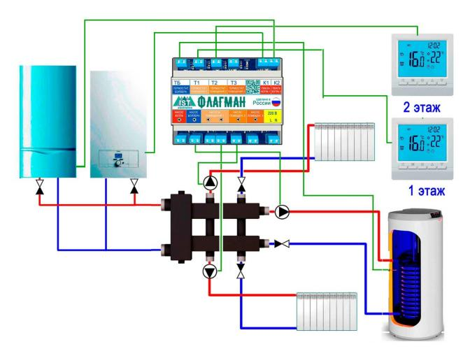
На Флагмане есть дополнительная пара клемм для управления вторым котлом. Не важно какой котёл, к какой паре клемм подключать.
