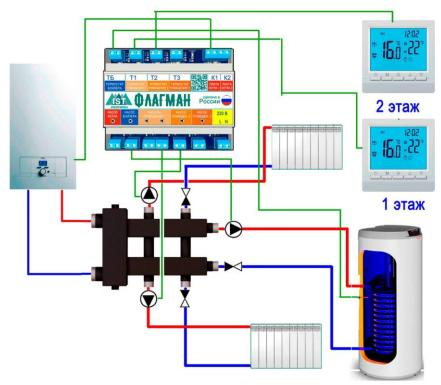
На контроллере Флагман предусмотрены все необходимые клеммы: котла, термостата первого этажа, термостата второго этажа и термостата бойлера.
