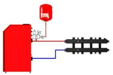
Циркуляция через котёл осуществляется насосами контуров отопления Если с котлом Вы будете использовать термостатический клапан, то нам понадобится коллектор с гидрострелкой.
