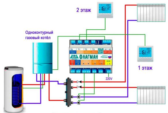
А в примере, который будет после этого, такая простая гидрострелка сможет работать и на тёплый пол. Одноконтурный газовый котёл хорош тем, что кроме системы отопления к нему напрямую можно подключить и бойлер косвенного нагрева. Для этого на нём есть пять
