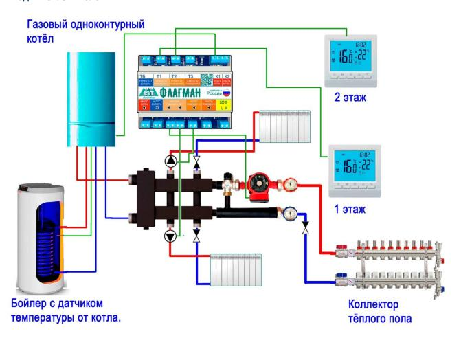
Горячий теплоноситель подаётся к радиаторам первого и второго этажа напрямую циркуляционными насосами. Можно применять как открытую разводку радиаторной системы по стенам, так и лучевую от радиаторного коллектора.
