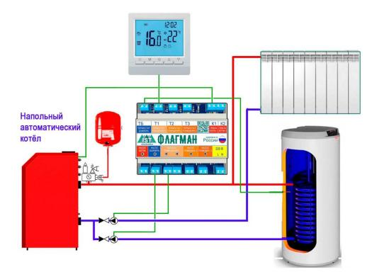
Тепло от котла разносится циркуляционными насосами. Их два: насос отопления и насос загрузки бойлера.
