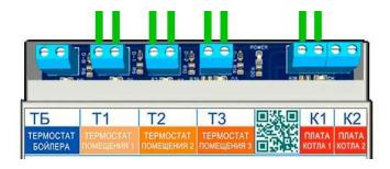
Насосы первого и третьего этажей присоединяем к соответствующим клеммам на контроллере Флагман. А если удобно, то просто соединяем провода одного этажа параллельно.
