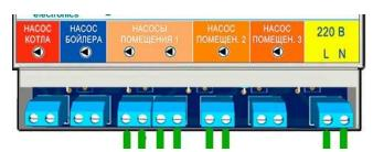
Обратите внимание, что на контроллере Флагман предусмотрено две пары клемм для подключения насосов первого этажа, потому что часто именно на первом этаже монтируют и тёплый пол и радиаторы.
