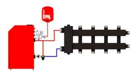
Коллектор с гидрострелкой так же необходим, когда котлов два. Здесь обязательны насосы на котлах вне зависимости есть термостатический клапан, или его нет.
