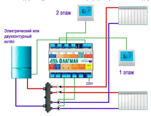
Применение двух насосов даёт возможность наладить поэтажный климат контроль путём пуска и остановки этих насосов контроллером по состоянию комнатных термостатов.
